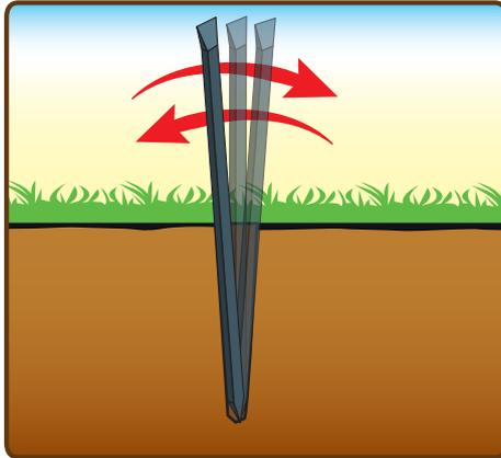
**2** Faire un pré-trou avec un pied de biche ou une barre à mine aux dimensions du support (hauteur + largeur).
