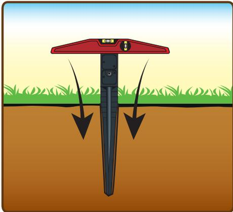
**4** Positionner le support dans le pré-trou. Ajuster le verticalement et horizontalement.
