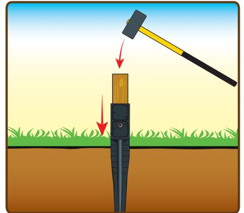
**6** Enfoncer le support à l'aide d'une massette pour commencer et une masse pour terminer les 10 ou 15 derniers centimètres.
